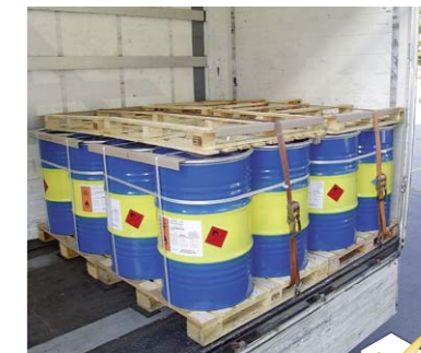
Sodi s čepom, pritrjeni na paleti. Nakladalne enote na paletah, pritrjene pod pravilnim kotom.
