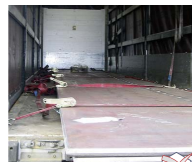
Tu je kot traku premajhen. Raglja ne sme biti napeta preko pločevine.
