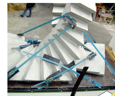
Tu je optimalna možnost direktno pritrjevanje. Pritrdilne točke so bile v stopnice vlite med proizvodnjo.
