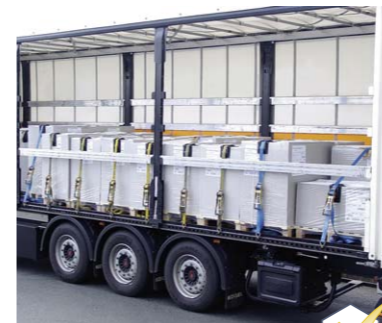
Papir v formatu na paletah, pritrjen pod pravilnim kotom in z zaščitnimi robniki.
