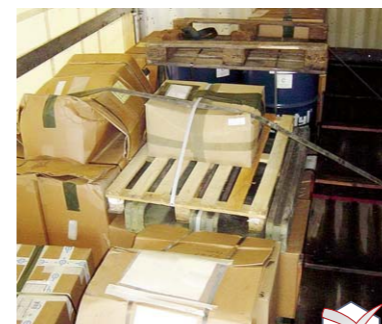
Škatle so premehke za privezovanje preko tovora. V tem primeru je bolje, da nakladalne enote pritrdimoz raztegljivo folijo oz. povezovalnim trakom.
