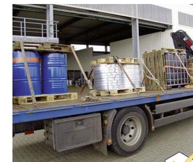
Različni načini vezanja. V tem primeru: privezovanje preko tovora in čelno privezovanje.
